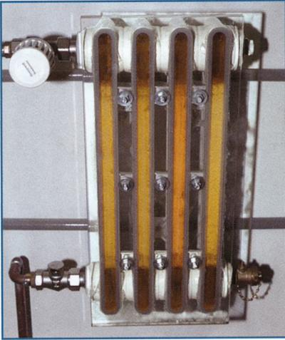
Verschiedene Metalle in Verbindung mit Wasser führen zu Rostbelag in Wand- und Fußbodenheizungsrohren
