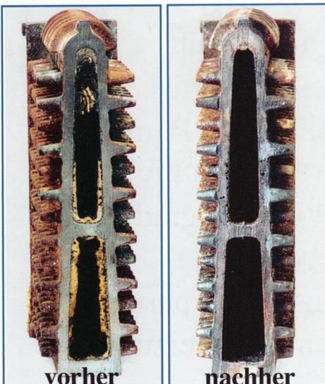
Kalkbeläge im Wärmeerzeuger führen zu Siedegeräuschen und Spannungsrissen im Kessel und zu Wirkungsgradverlust
